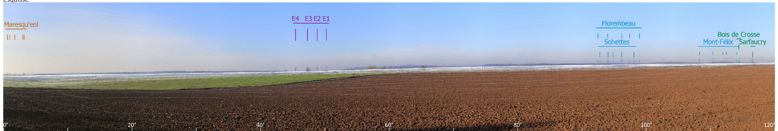
Les éoliennes sont représentées dans les mêmes couleurs que les cartes, sans prise en compte des masques visuels. Le relief est pris en compte et mis en évidence sur cette esquisse par une trame blanche.
