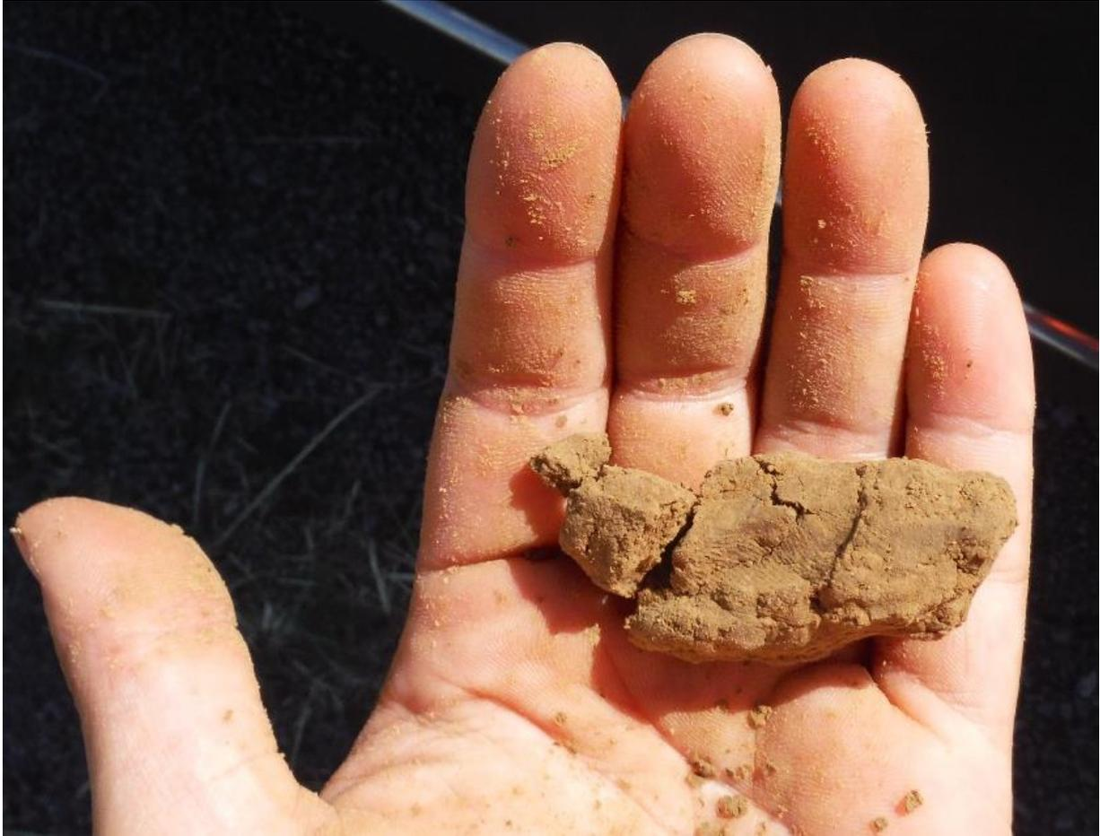
**Photographie 1 : Test du boudin, ici nous observons le désassemblage du boudin ce qui montre la nature sableuse du sol**
